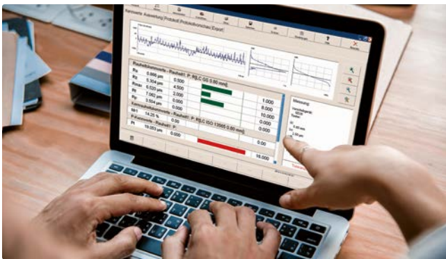
Ansicht „Auswertung“: Ergebnis mit Profil, ADK-Kurve, Mr-Kurve und Toleranzüberwachung
